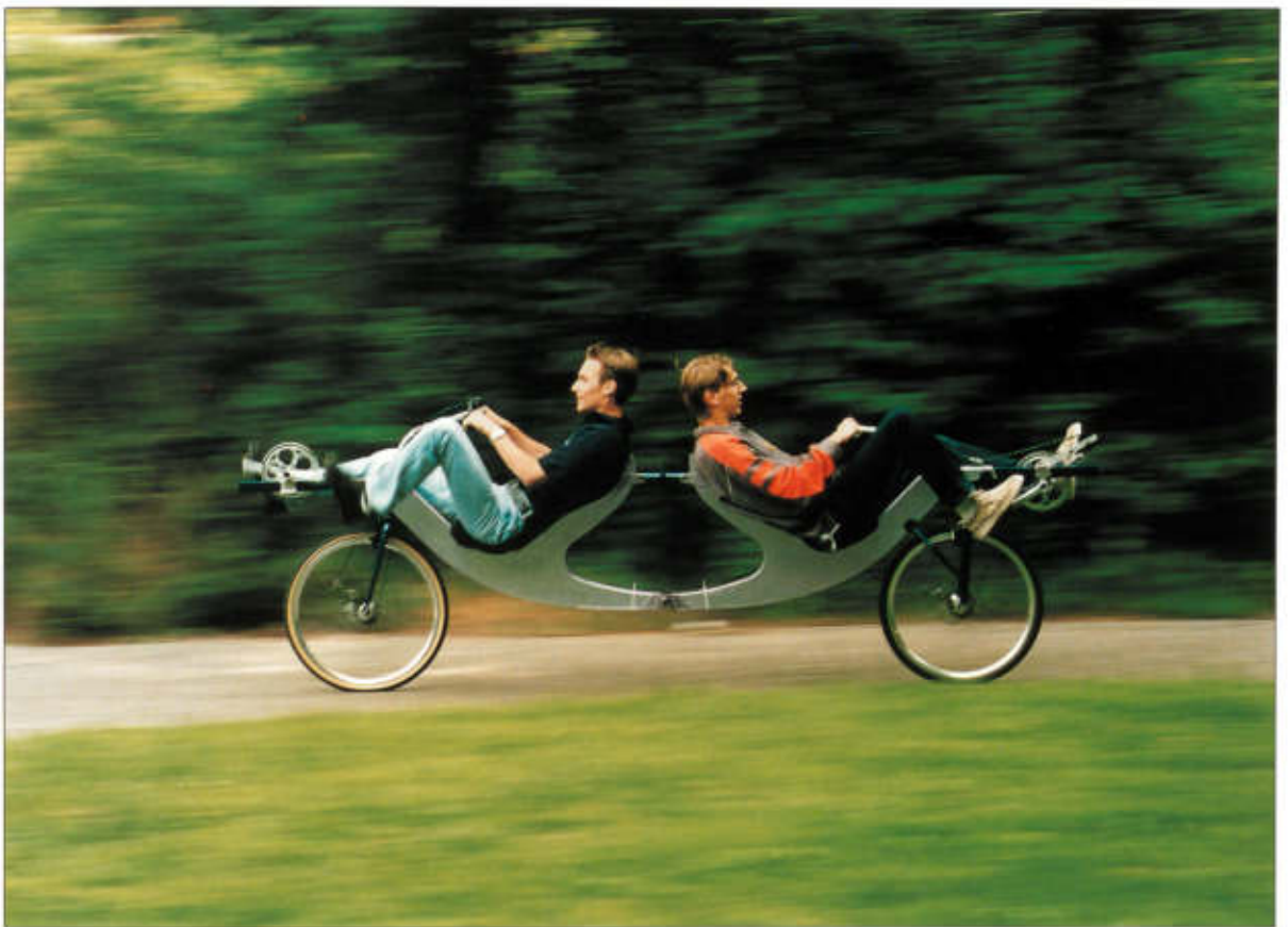
»Flevobike«; Rücken-an-Rücken-Tandem; Aluminium, Kunststoffschaukern; L 300 cm, 25 kg
