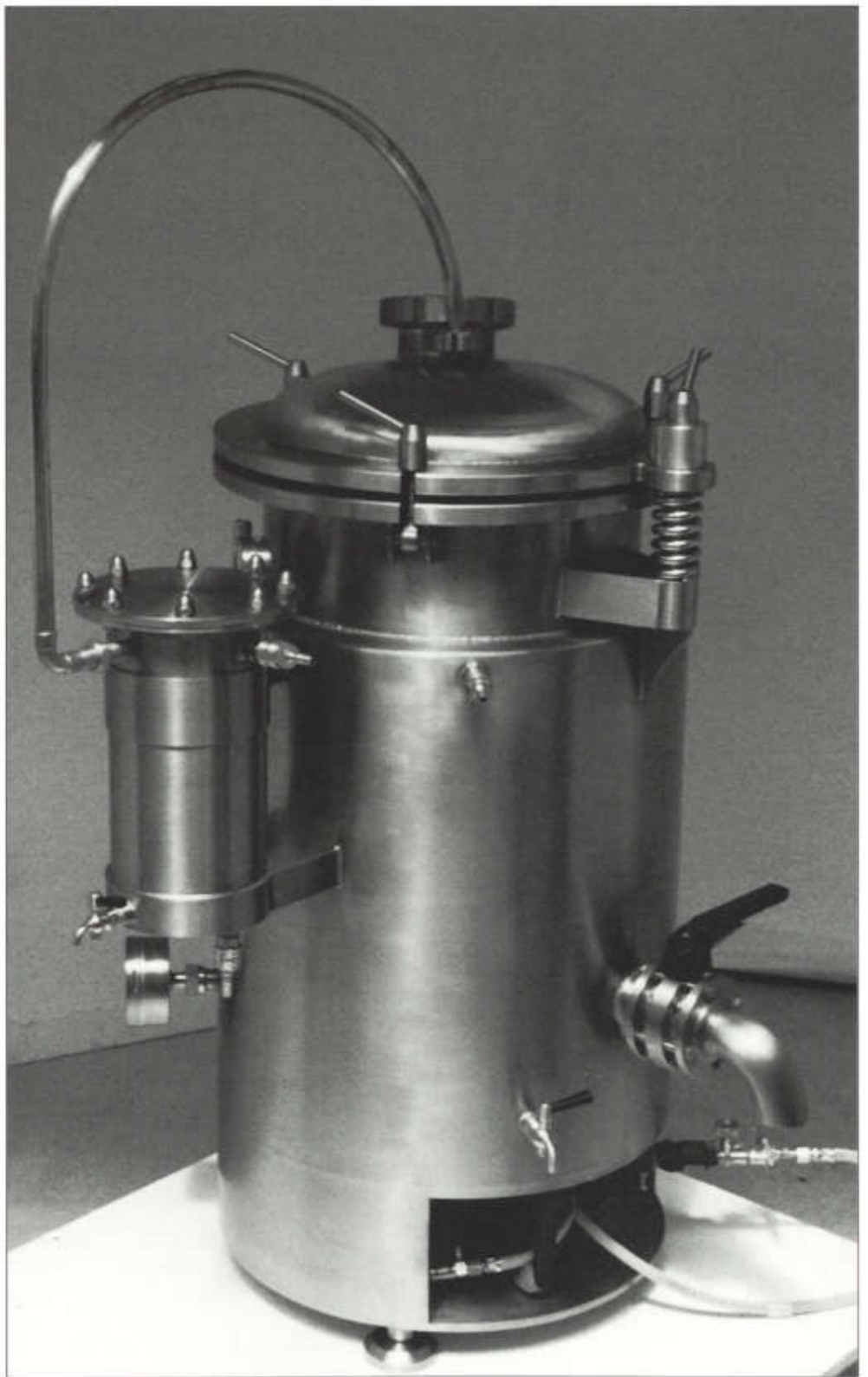
Destillierapparat; Chromnickel, Kupfer, Kupferzink; H 120 cm, Ø 80 cm
