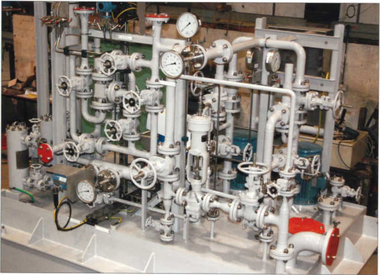
Schmierungseinheit für eine Raffinerie bei Abu Dhabi/VAE; 250x150x300 cm
