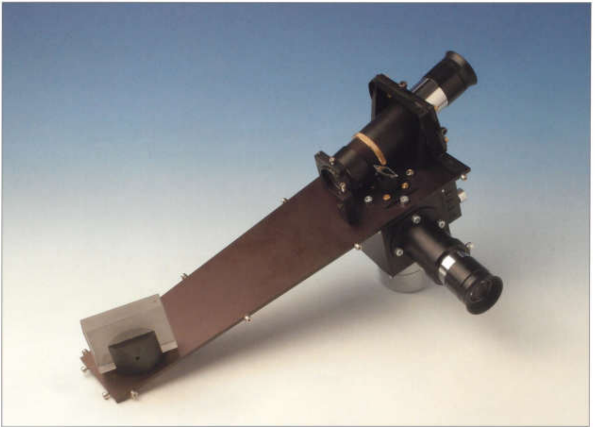
BACHES; Echelle-Spektrograph zur Zerlegung von Sternenlicht; 16,5×33,5×15 cm
