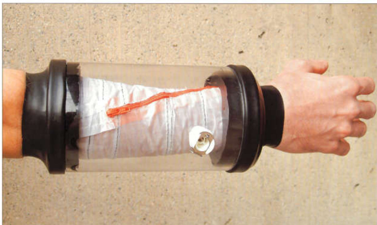
Sektion eines Hybrid-MCP-Raumanzugs in der Vakuumkammer; Polyestergewebe, Urethanblase; 53x53x30cm
