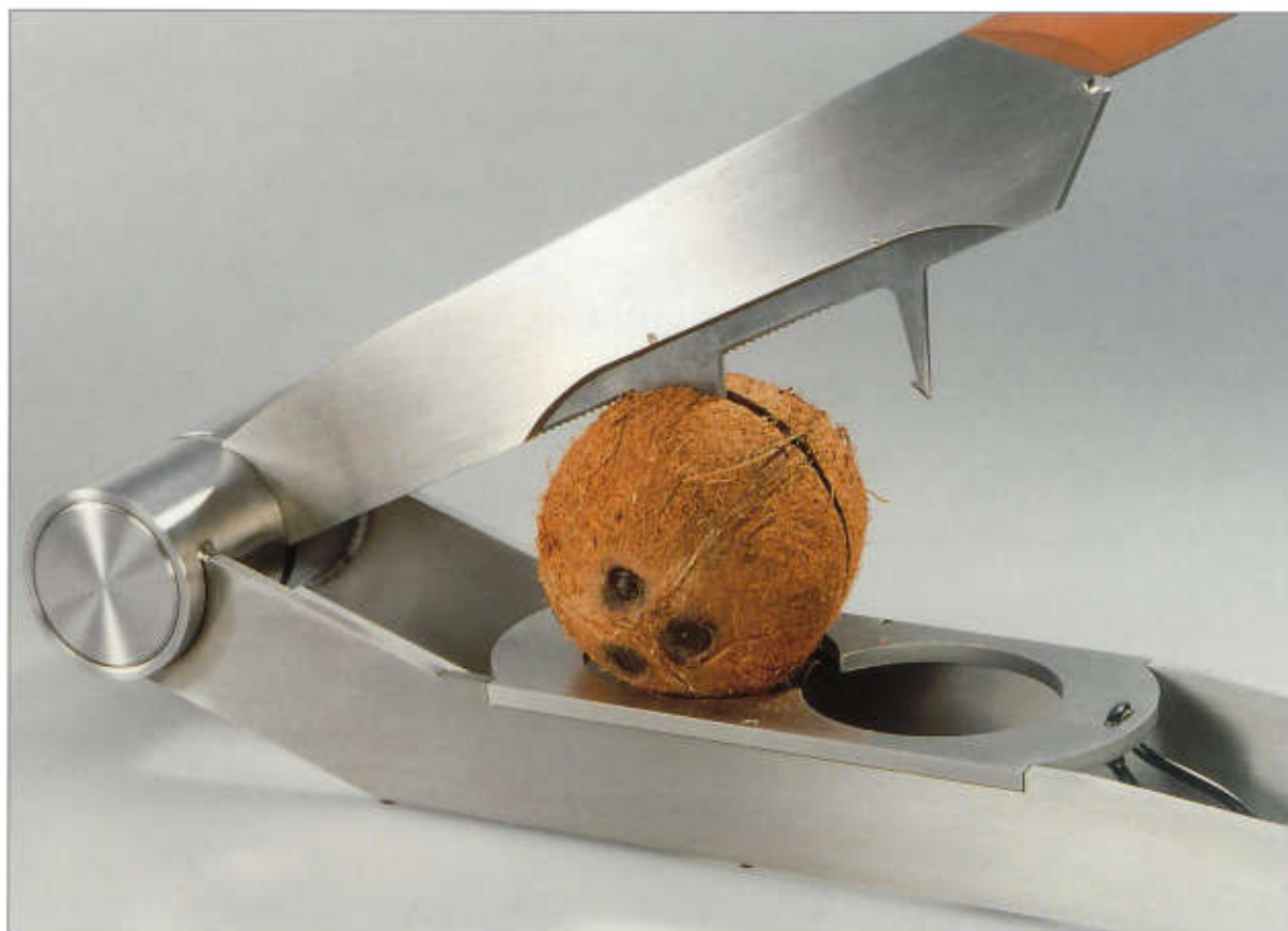
»Krokodil«; Kokosnussschneider; Silber, Birnbaumholz, Edelstahl, wasserstrahlgeschnitten, 10 c-gefräst, verstiftet, verschraubt; 12x54x14cm
