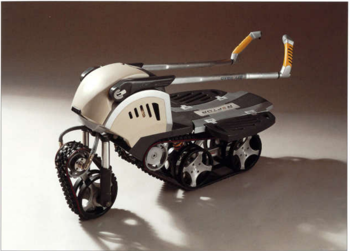
»Reptor«: klappbares Fun-Mobil zu Freizeit Zwecken; Aluminium, ABS-Kunststoff, Gummi, Eisenrohre; 115x100x30cm, Gewicht 30 kg
