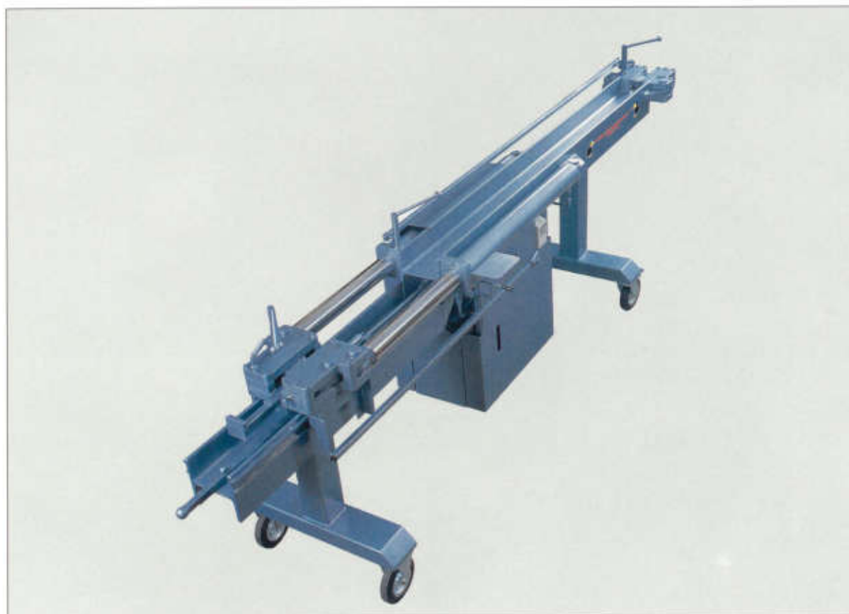
Stabstahlreckmaschine zum Richten von Stabstahl; Grundgerüst: IPB 200, Baustahl, hydraulisch betrieben; 300 x 70 x 110 cm
