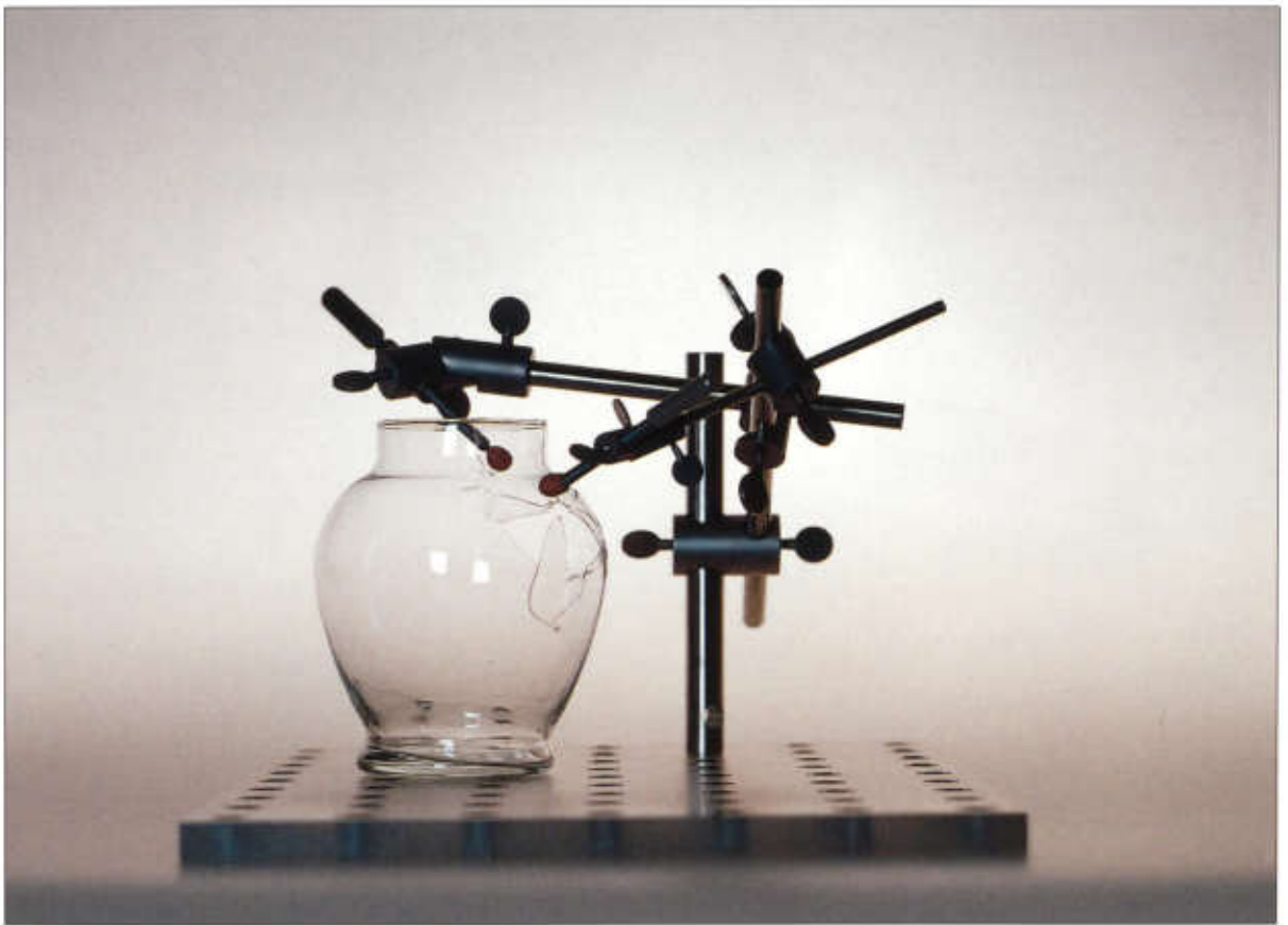
Positionier- und Fixier-Einheit für Restauratoren; Edelstahl, Acrylglas; 40 x 30 x 40 cm
