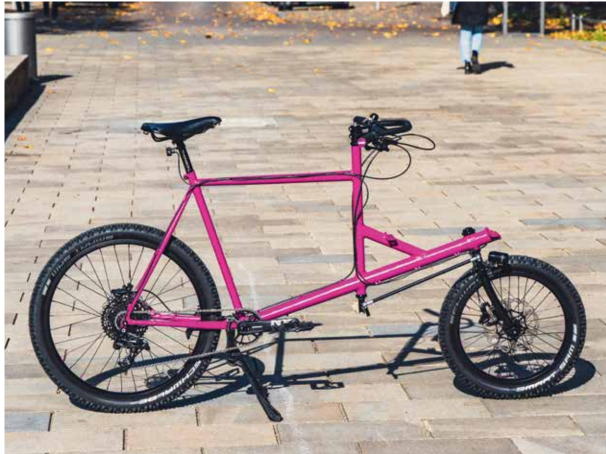
Nachhaltiges Lastenrad; Stahl, Aluminium, Holz, Gummi, Stahl, hartgelötet, pulverbeschichtet; 110x80x170 cm; Foto: Johannes Wandering
