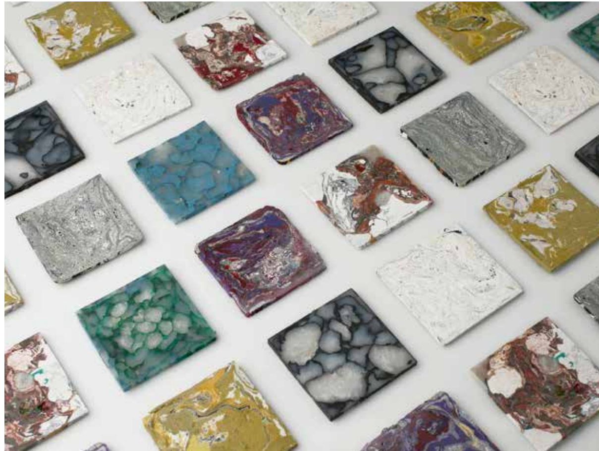
„PLASTIC STONE TILES“; Kunststoff-Fliesen; Polypropylen (PP), Polyethylen (LDPE), Gesteinsimitation; je 0,4x9x9 cm; Foto: KISD Fotostudio
