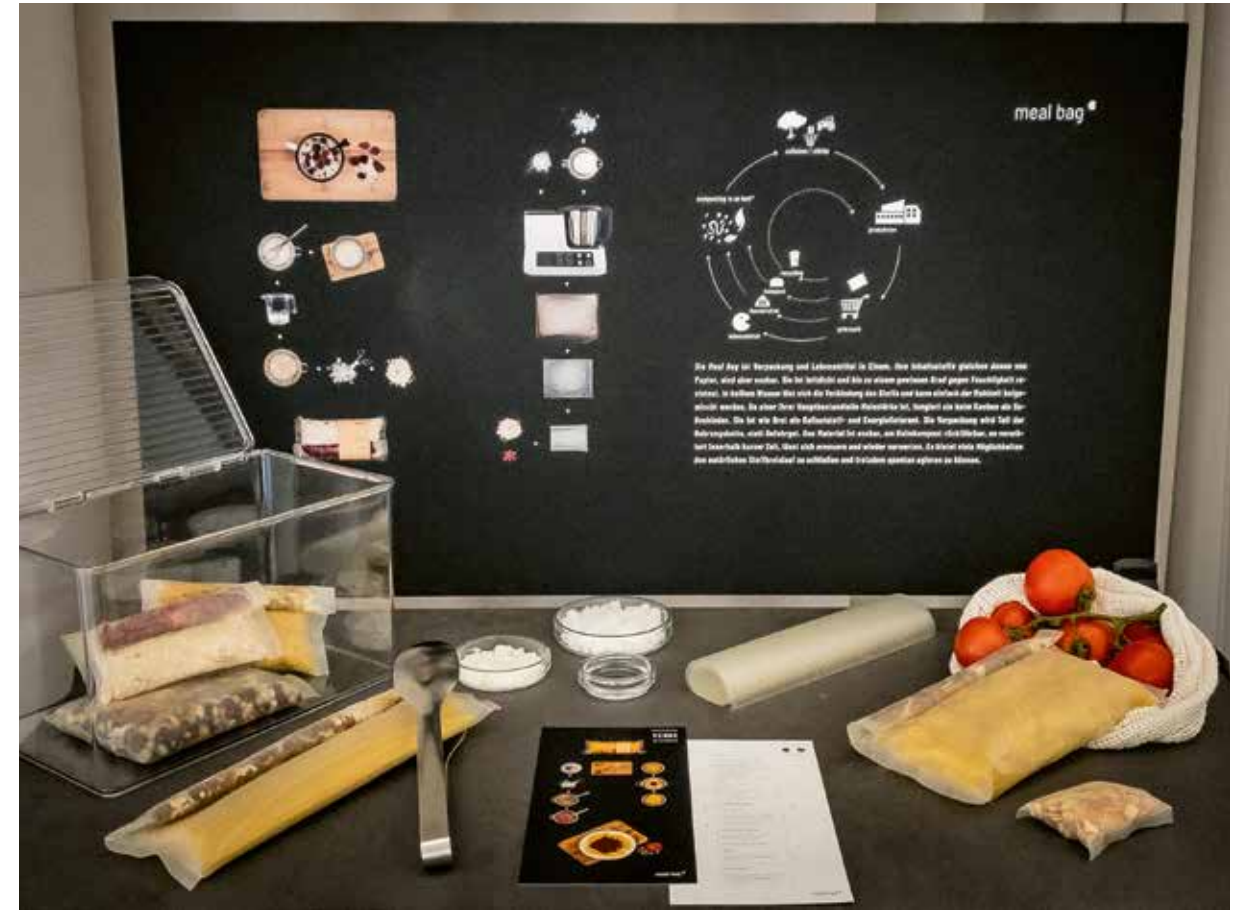
„MEAL BAG“; Prototyp; eigens entwickelter essbarer Biokunststoff, gekocht, getrocknet; 150x90x50 cm; Foto: Amelie Graf
