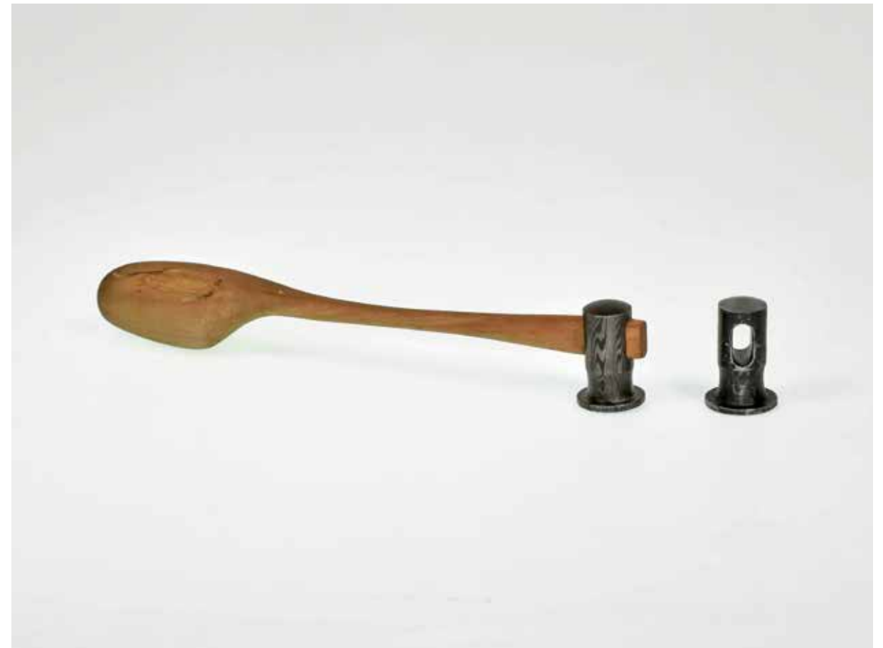
Ziselierhammer und Hammerkopf für einen Goldschmiedehammer; Schneckendamast, geschmiedet, Edelhölzer; ca. 30x4x5,5 cm, 2,5x2,5x5 cm Foto: Simon Haueis
