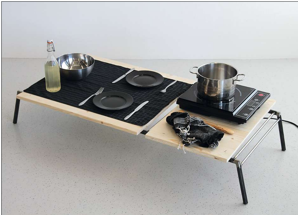
»Essentielle Küche«; Metallgestell mit Steckverbindung und aufliegender Holzplatte; Stahlrohr, geschweißt, brüniert, Fichtendreischichtplatte, gedübelt, geschliffen, geölt; 80×120×60 cm. Foto: Anna Gramberger/Livia Teubersen
