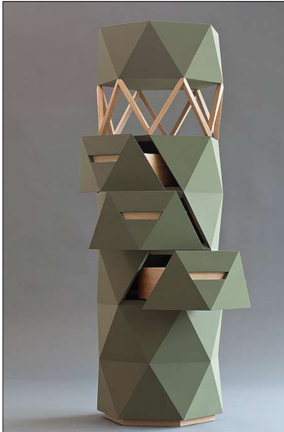
Meisterstück; Eiche geölt, MDF, in Nextel lackiert, gesägt, gefräst, gebohrt, geschliffen, verleimt, geölt, lackiert; 140,7×46×46 cm
