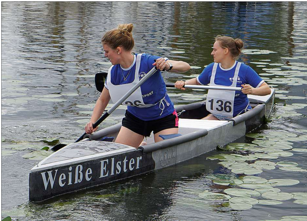
»Weiße Elster«; Kanu; Beton, Glasfaser, Stahl, Laminieretechnik, Segmentierung; 32×72×518 cm
