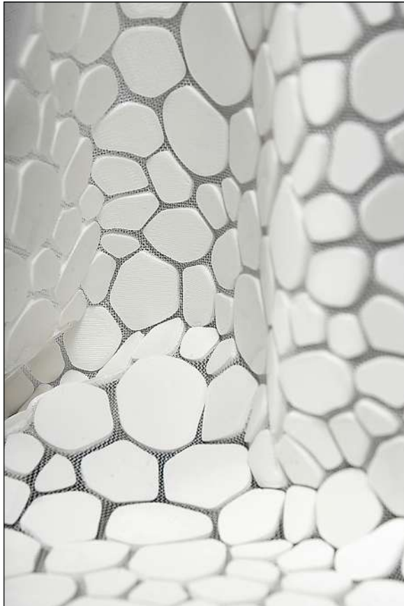
Textile Fläche; Maschenstoff mit Polylactid (PLA), 3D-Druck auf Textil; 28×28×0,2cm
