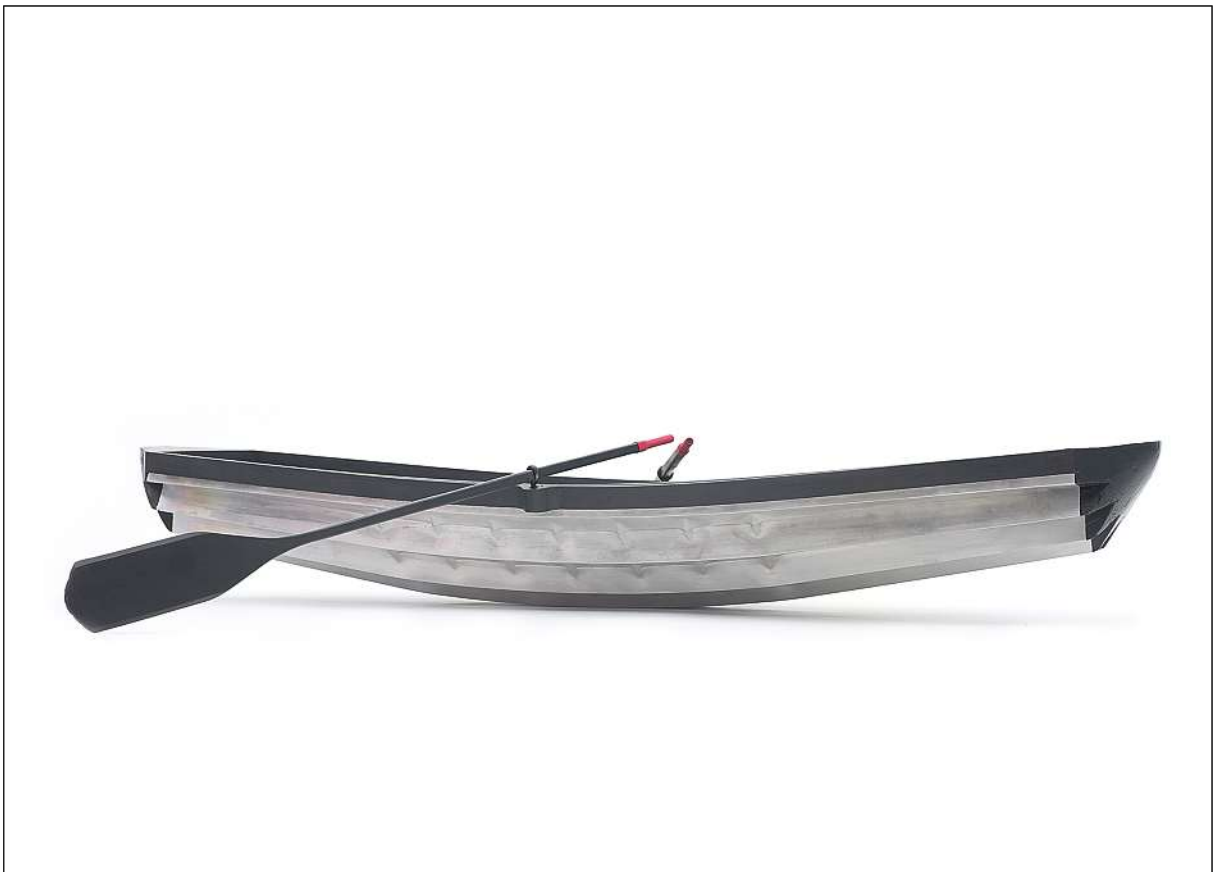
»SKIFF«; Ruderboot; Edelstahl, Aluminium, Eichenholz, lackiert; 330×111×60 cm
