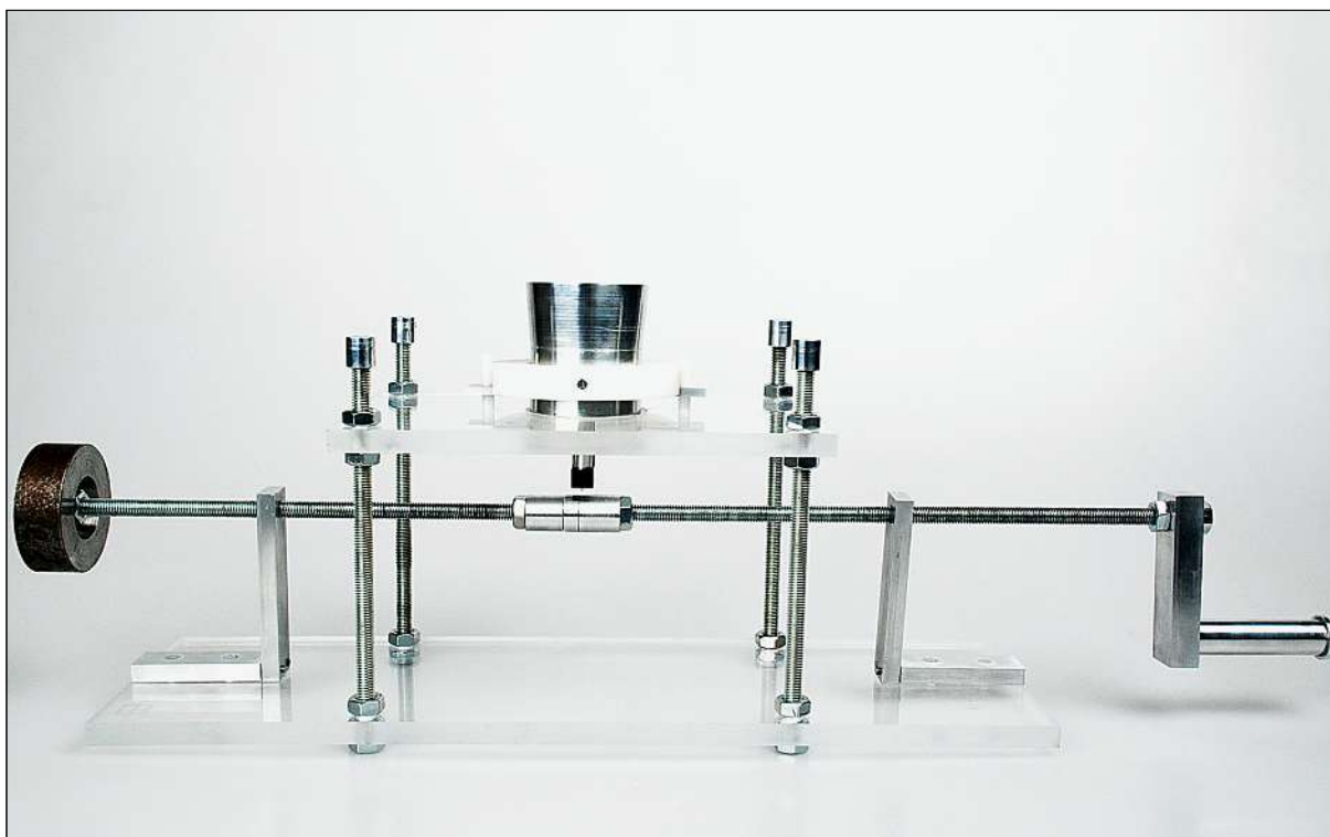
Maschine zum Eingravieren von Ton- und Geräuschsequenzen in einen Silber- oder Aluminiumring; Aluminium, Plexiglas, Silberring; 25×50×20 cm, 0,6×2,1×2,1 cm
