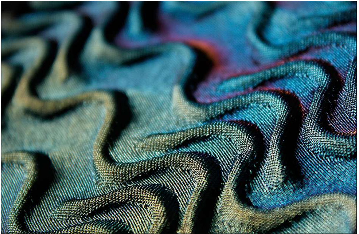
Textil aus der Serie »Rise and Shine«; Polyester mit verschiedenen Schrumpfgarnen, Gewebe mit PVD-Beschichtung (Aluminium und Titanoxinitrid); 16×21×1 cm
