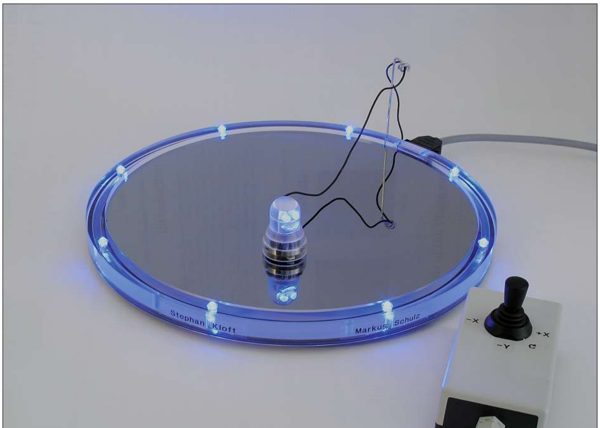
Piezogetriebener Stick-Slip-Roboter auf 12 Zoll Silizium-Wafer, Joystick zur interaktiven Steuerung; Piezotechnik, Mikroelektronik; 4×33×33 cm
