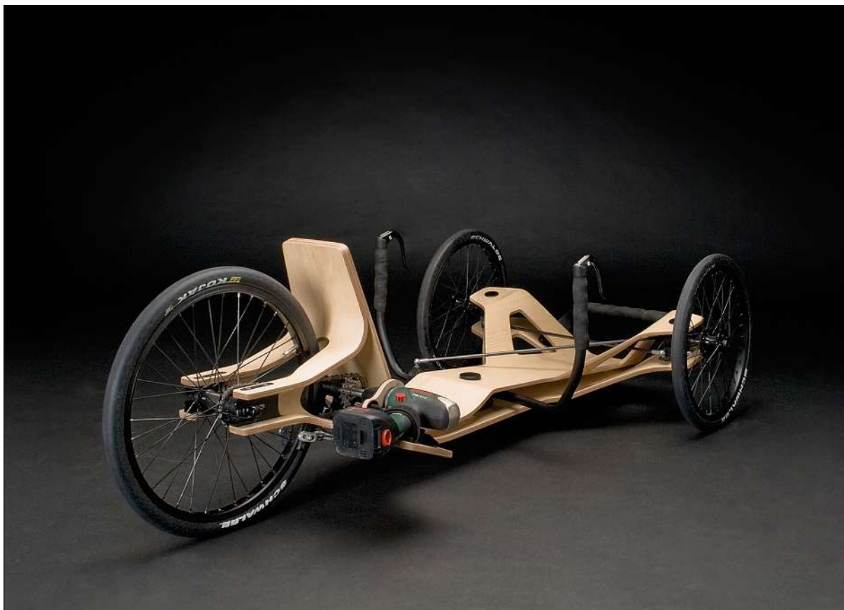
Fahrzeug »Rennholz«; Formholz, Aluminium, Fahrradtechnik; 50×70×165 cm
