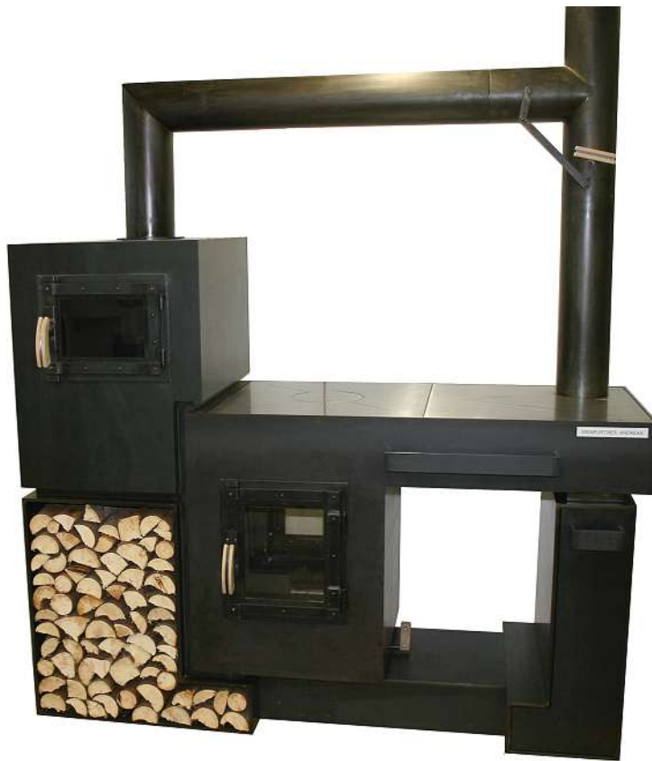
»Back to the roots«; Herd mit Backfach und Kochfeld; Stahl S235JR, geschweißt, verschraubt, genietet, verzündert, kaltbrüniert, Holzgriffe; 202×164×60 cm
