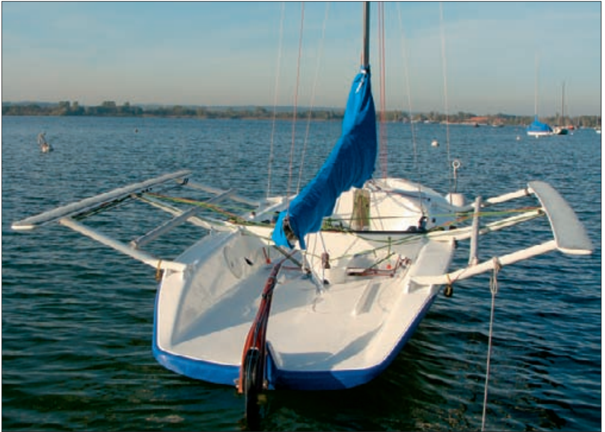
Zirron »No Trapeze«; Kohlefaser-Sandwich, Vakuumverfahren; 12×3,5×7,5 m
